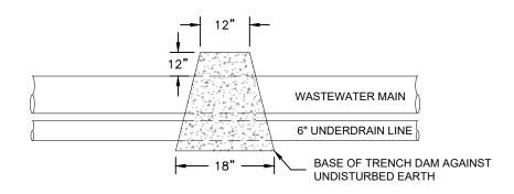
1. TRENCH DAMS ARE REQUIRED AT THE TRANSITION FROM ACTIVE UNDERDRAINS TO PASSIVE UNDERDRAINS.
